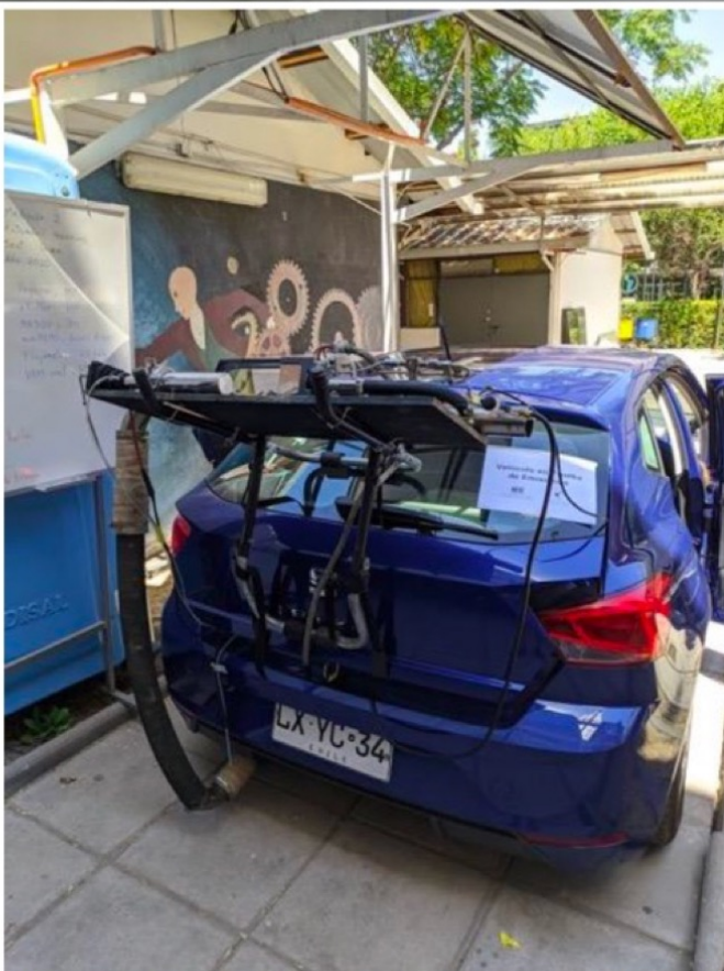
Figura 9. Montaje de analizadores en vehículo gasolina (izquierda) y diésel (derecha)
